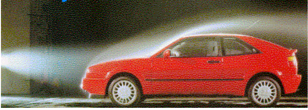
Şekil 3.18 Rüzgâr tüneline Volkswagen otomobilin üzerindeki hava akış şekli
