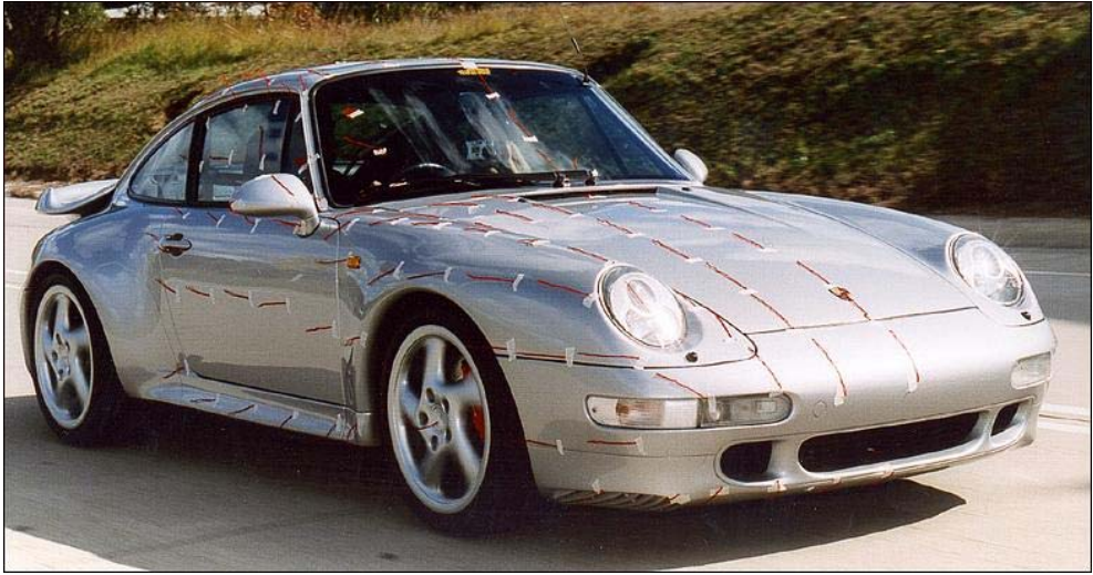
Şekil 3.15 Otomobilin üzerindeki akış yönüyle kolayca bükülebilen püsküller
