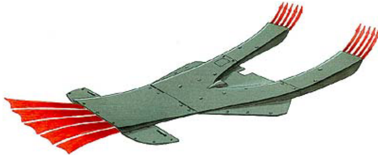
Şekil 2.11 Yer etkisi oluşturmak için taşıtın alt kısmına yerleştirilen kanallar
