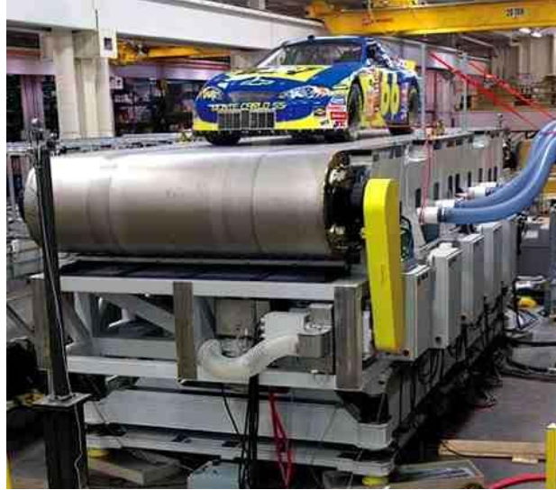
Şekil 3.10 Hareketli kayış mekanizması (rüzgâr tüneline yerleştirilmemiş)
