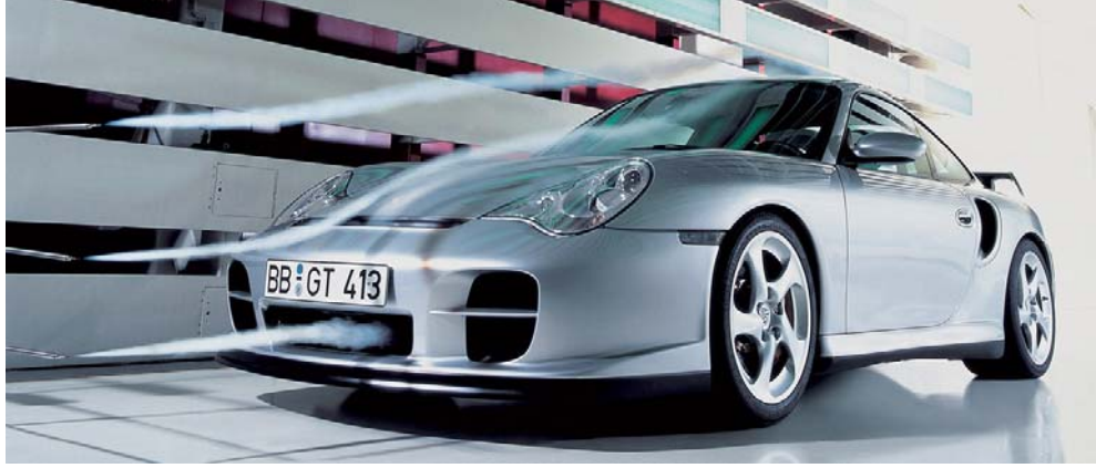
Şekil 3.16 Taşıt üzerine duman püskürtülmesi
