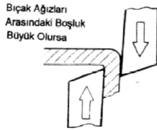
Çizim 133 Döndürme momenti nedeniyle iş parçasının makas bıçakları arasına sıkışması.
