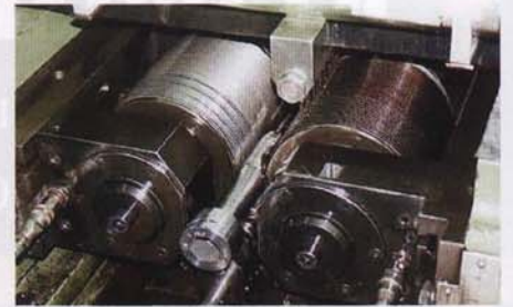
Şekil 3. Ovalama yöntemiyle civata-vida dişi imalatı (3,5)
