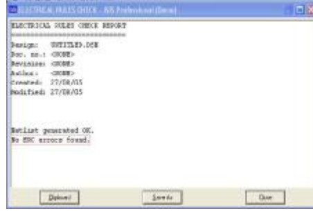
Şekil 5.41: Elektriksel hata testi
