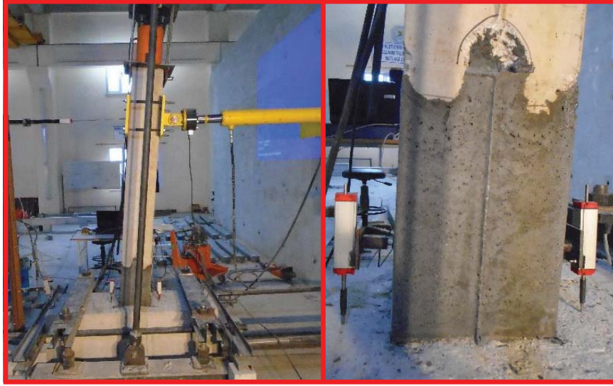
Şekil 12. UYDLB ile güçlendirilmiş Kolon-1'in yatay yük altındaki testi
