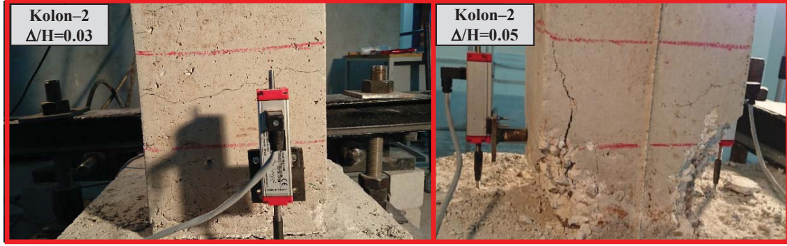
Şekil 8. Kolon-2'de farklı öteleme değerleri için çekme ve basınç bölgesi hasarları
