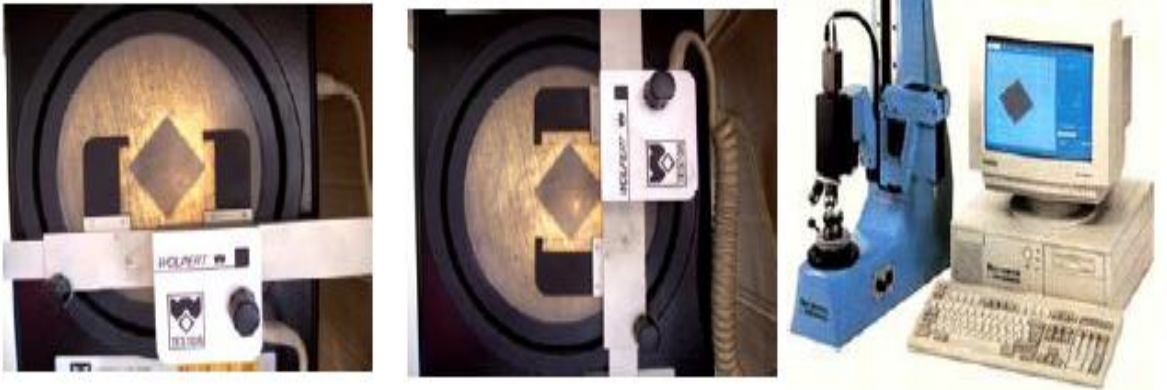
Resim 3.3: Numune üzerinde meydana gelen izin metalurji mikroskobu yardımı ile ekrana aktarılması
