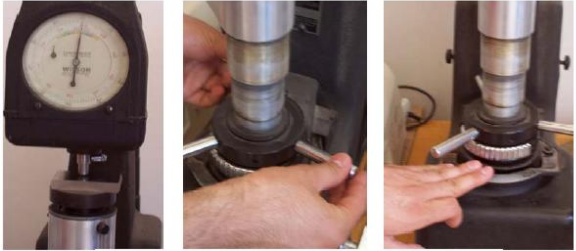
Resim 2.3: Numune malzemenin cihaza yerleştirilmesi ve yükün sıra ile uygulama aşamaları
