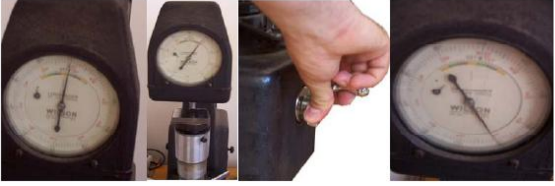
Resim 2.4: Sertlik deęerini cihazdan okuma ařamaları. (Ön ve ana yükün uygulanması, ana yükün kaldırılması ve deęerin okunması)
