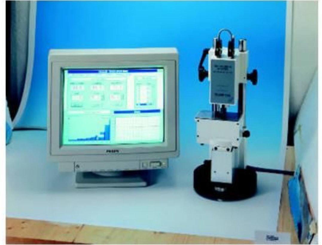
IRHD Shore Sertlik Ölçme (6 mm den kalın lastik ve plas tikler için)
