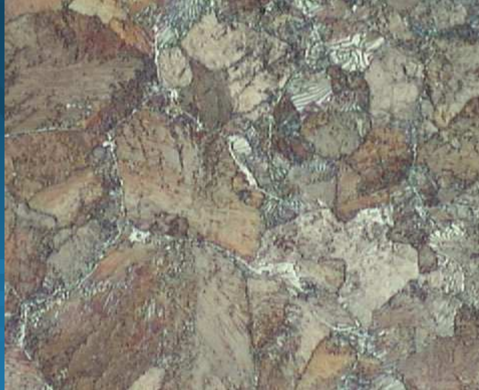
Sementit yapı ( \text{Fe}_3\text{C} )
