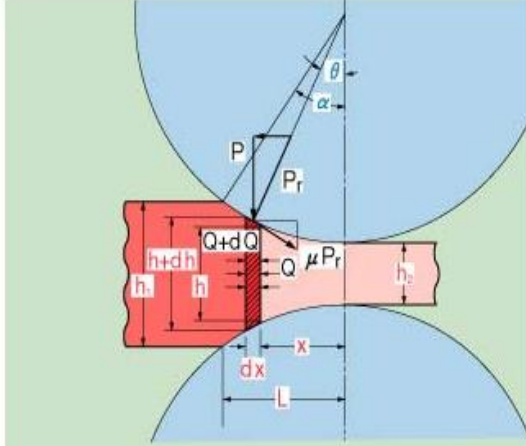
a)-haddelemede mlz boyutu ve gerilmesi
