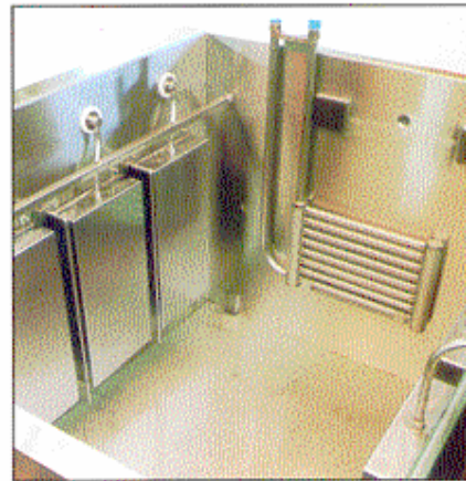
Şekil 6 . Temizleme tank'ının iç yapısı ve transducer'in yerleşimi . 1. Isıtma ON/OFF düğmesi 2. Termostat 3. Rezistans 4 .Su boşaltma vanası 5 .Taşma deliği 6 .PZT transducer'i
