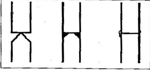
Şekil 4: Sivri uçlu ve kalın cidarlı parçalarda doğan problemler
