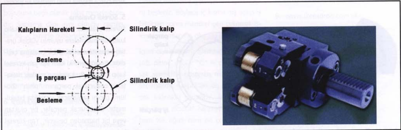
Şekil 10. Teğetsel beslemeli ovalamanın çalışma prensibi (9,10)
