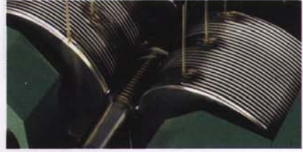
Şekil 5. İki ve üç kalıplı içten beslemeli silindirik ovalama (3)
