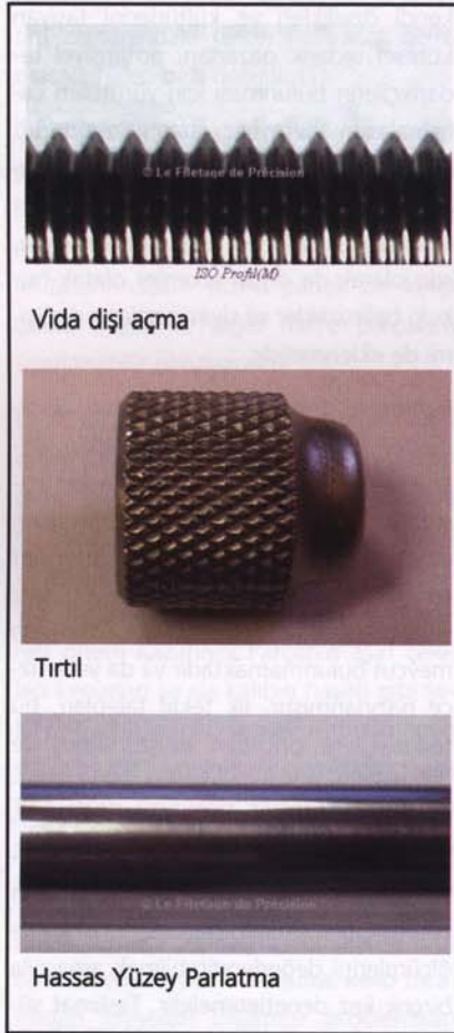
Şekil 1. Ovalama yöntemiyle yapılan işlemler (1).
