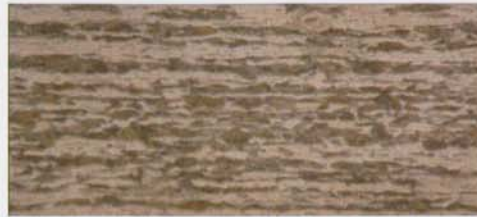
Fig. 13: Optical microscope pictures of sample 7 (Pt=162 MPa, Pu=121.5 MPa) (500x) Bild 13: Optische Mikroskopieaufnahmen der Probe 7 (Pt=162 MPa, Pu=121.5 MPa) (500x)
