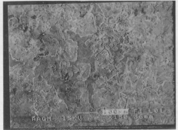
Şekil 7. 560°C, 4.5 MPa, 60 dak deney şartlarında kaynak edilmiş numunenin kırılma yüzeyinin SEM görüntüsü
